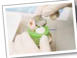
電子工作をセットした土台にグルーガンで具を接着。空き瓶をかぶせてフタを閉めると完成です。
